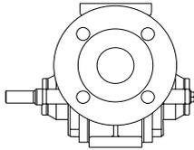
**Selbstansaugende Flügelzellenpumpe für dünn- und zähflüssige Mineralölprodukte und andere nicht korrosive und / oder feststofffreie Medien.
