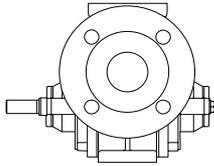
**Selbstansaugende Flügelzellenpumpe, für dünnflüssige Mineralölprodukte und andere nicht korrosive und / oder feststofffreie Medien.**
