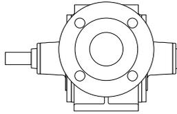
Selbstansaugende Flügelzellenpumpe für dünnflüssige Mineralölprodukte, Lösemittel und andere nicht korrosive und / oder feststofffreie Medien.
