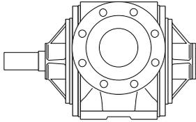
**Selbstansaugende Flügelzellenpumpe, für dünnflüssige Mineralölprodukte und andere nicht korrosive und / oder feststofffreie Medien.**
