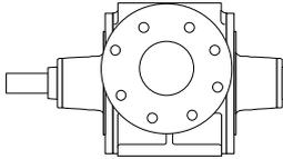
**Selbstansaugende Flügelzellenpumpe, für dünnflüssige Mineralölprodukte und andere nicht korrosive und / oder feststofffreie Medien.**
