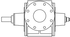
**Selbstansaugende Flügelzellenpumpe für dünn- und zähflüssige Mineralölprodukte und andere nicht korrosive und / oder feststofffreie Medien.
