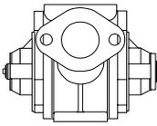
**Selbstansaugende Flügelzellenpumpe, für dünnflüssige Mineralölprodukte und andere nicht korrosive und / oder feststofffreie Medien.**
