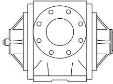
**Selbstansaugende Flügelzellenpumpe für dünn- und zähflüssige Mineralölprodukte, Lösemittel und andere nicht korrosive und / oder feststofffreie Medien, sowie Medien mit hohem spez. Gewicht.
