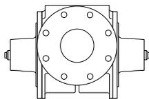
Selbstansaugende Flügelzellenpumpe, für dünnflüssige Mineralölprodukte und andere nicht korrosive und / oder feststofffreie Medien.
