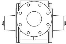
**Selbstansaugende Flügelzellenpumpe für dünn- und zähflüssige Mineralölprodukte und andere nicht korrosive und / oder feststofffreie Medien.
