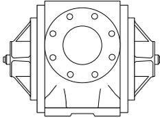
**Selbstansaugende Flügelzellenpumpe, für dünnflüssige Mineralölprodukte und andere nicht korrosive und / oder feststofffreie Medien.**
