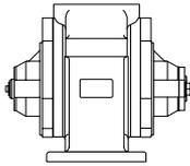
**Selbstansaugende Flügelzellenpumpe für dünn- und zähflüssige Mineralölprodukte und andere nicht korrosive und / oder feststofffreie Medien.
