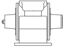
**Selbstansaugende Flügelzellenpumpe für dünn- und zähflüssige Mineralölprodukte und andere nicht korrosive und / oder feststofffreie Medien.
