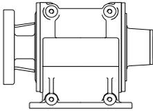
**Selbstansaugende Flügelzellenpumpe für direkt in die Welle einzusteckenden Hydraulikmotor, für dünnflüssige Mineralölprodukte und andere nicht korrosive und / oder feststofffreie Medien.**
